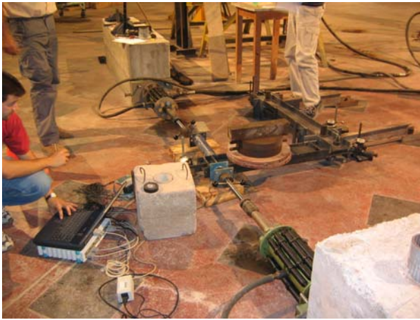
Foto 10a: Pieza metálica, gatos hidráulicos y dispositivos de adquisición de datos de fuerzas y desplazamientos.
