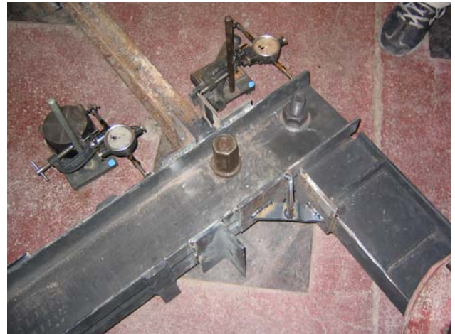
Foto 10b: Nudo articulado viga-columna con disipador metálico y flexímetros de control de giros adicionales en la articulación.
