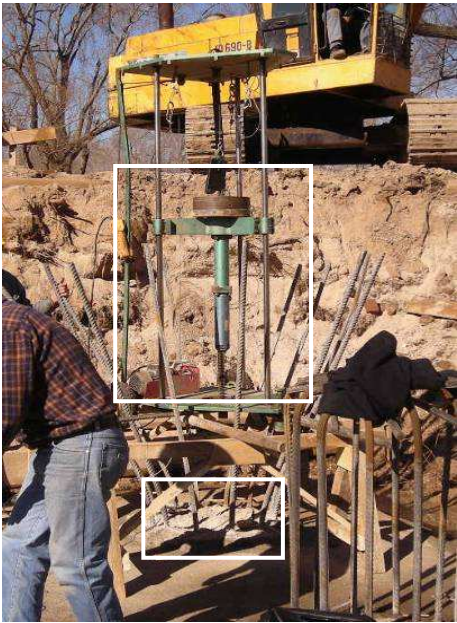
Figura 9. Ensayo dinámico del pilote
