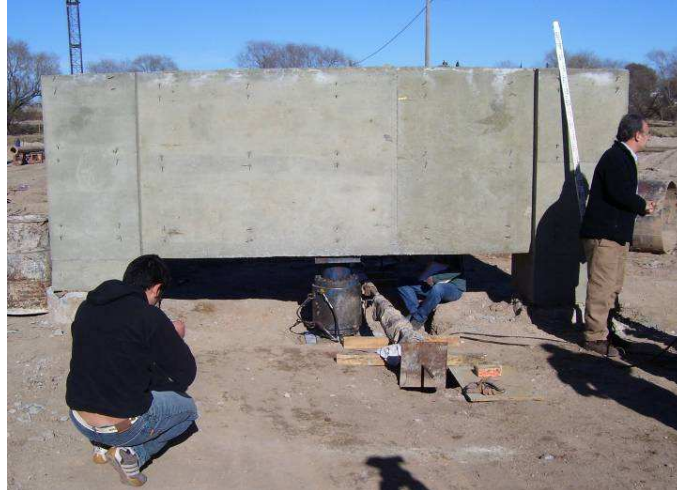
Figura 11. Viga de reacción y gato hidráulico utilizado en el ensayo de carga estático del Pilote N°8
